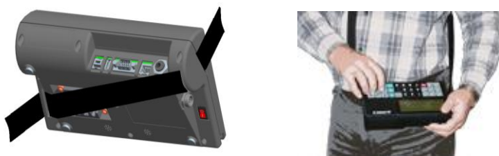
Рис. 2.3 - Крепление ремня для переноски терминала RC
