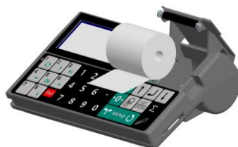
Рис. 2.4 - Заправка бумаги в терминал RC
