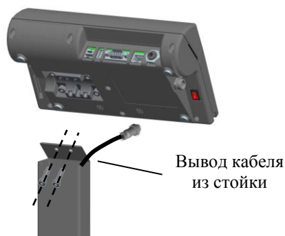
Рис. 2.2 - Крепление терминала RC на стойке весов МК и ТВ
