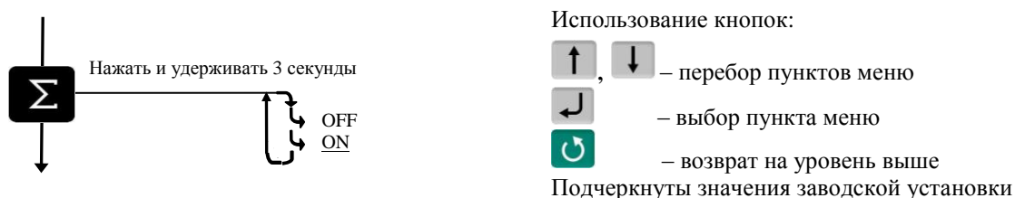
Рис. 4.2 - Схема включения/отключения встроенного принтера
