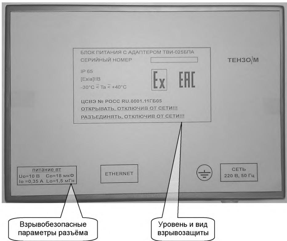
Рис.7 .3. Внешний вид БПА Преобразователя спереди.
