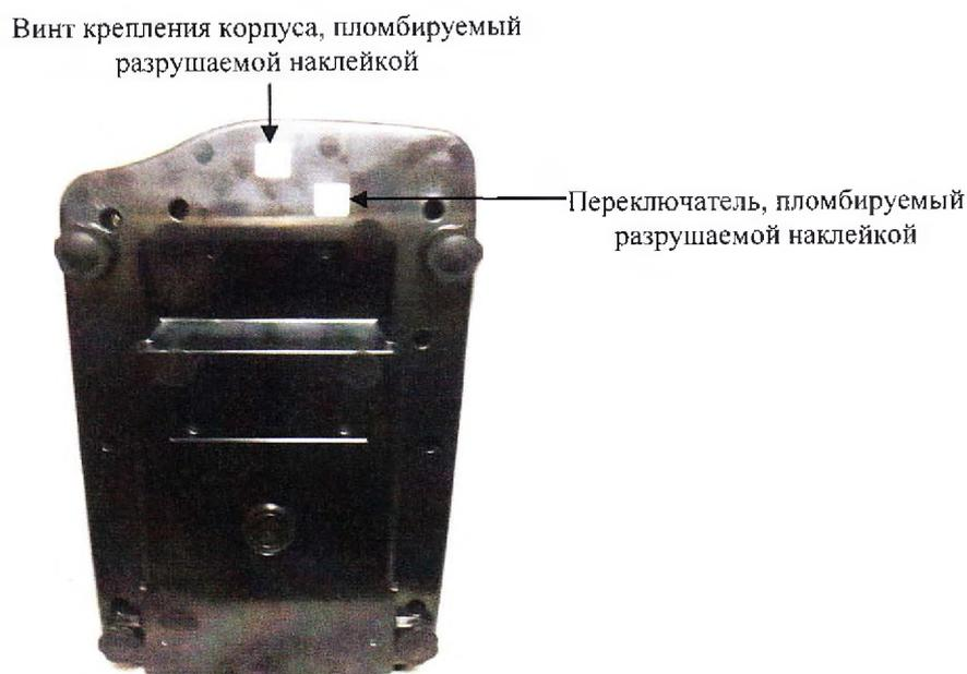
Рисунок 2 - Схема пломбировки весов от несанкционированного доступа.
