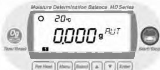
Для выхода из меню "UNIT" нажмите кнопку [Menu]. На экране начинает отображаться вес в граммах.
