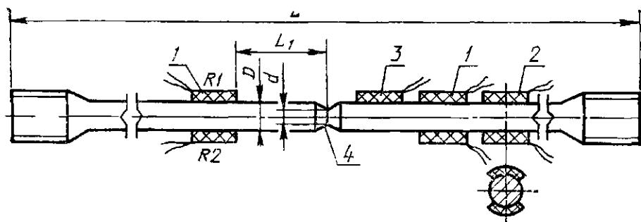
Сталь У8А. Галить в зоне выточки до твердости 63—65 HRC,
