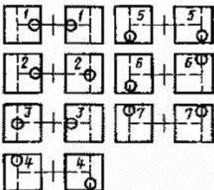
На настольных гирных и циферблатных весах с двумя площадками парные образцовые гири размещают в центре площадок, а затем в положения, указанные на чертеже. Если при каком-либо положении гирь настольные гирные весы не придут в положение равновесия, то при помещении на соответствующую чашку гири-допуска, равной по массе допускаемой погрешности, указатели должны сойтись или перейти положение равновесия.
