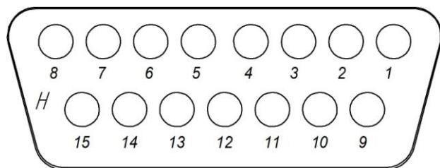
Рисунок А.4—Разъем (со стороны терминала) «Мама» для подключения дублирующего дисплея нумерация со стороны монтажной части. Для подключения используется разъем «Папа» (входит в комплект поставки)
