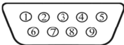
Рисунок А.3—Интерфейсный разъем (со стороны терминала) «Папа» нумерация со стороны монтажной части. Для подключения используется разъем «Мама» (входит в комплект поставки)
