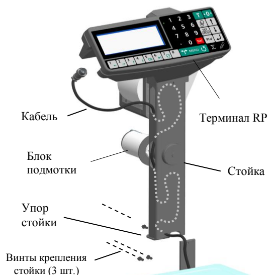
Рис. 3.3 - Сборка весов МК_RP10-1, МК_R2P10-1
