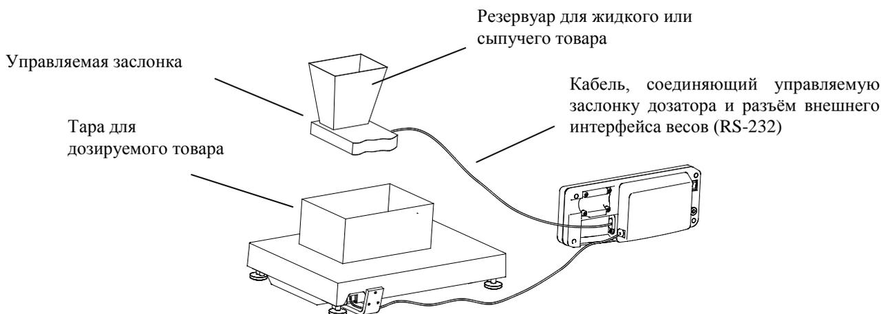
Рис. 7.2 - Подключение весов к дозирующему устройству
