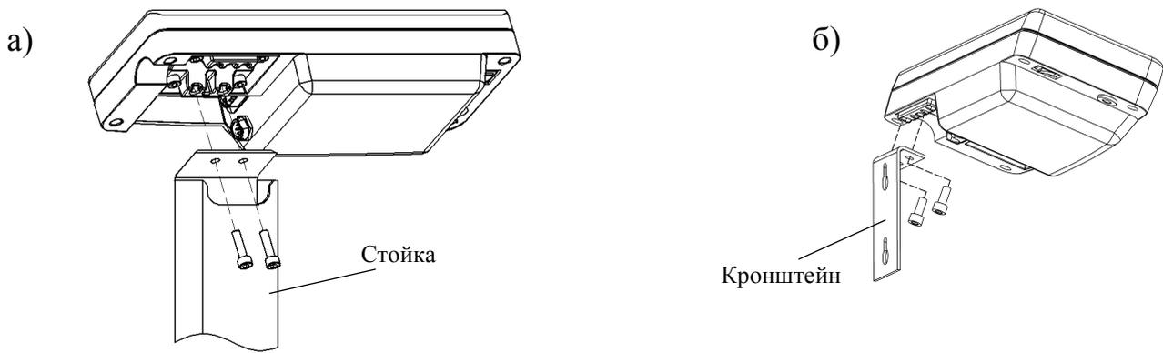
Рис. 5.3 - Варианты крепления устройства управления
