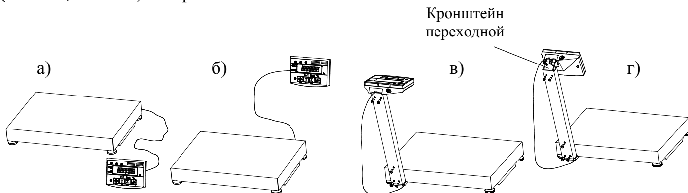
Рис. 6.1 - Варианты размещения устройства управления:
