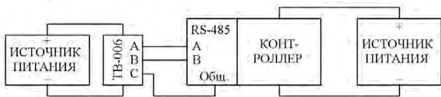
Функцию общего провода RS-485 может выполнять общий провод источника питания, к которому подключены эти устройства:
