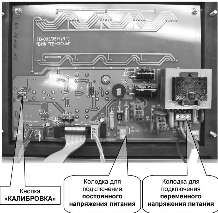
Рис. 4.4. Вид Преобразователя сзади со снятой крышкой.
