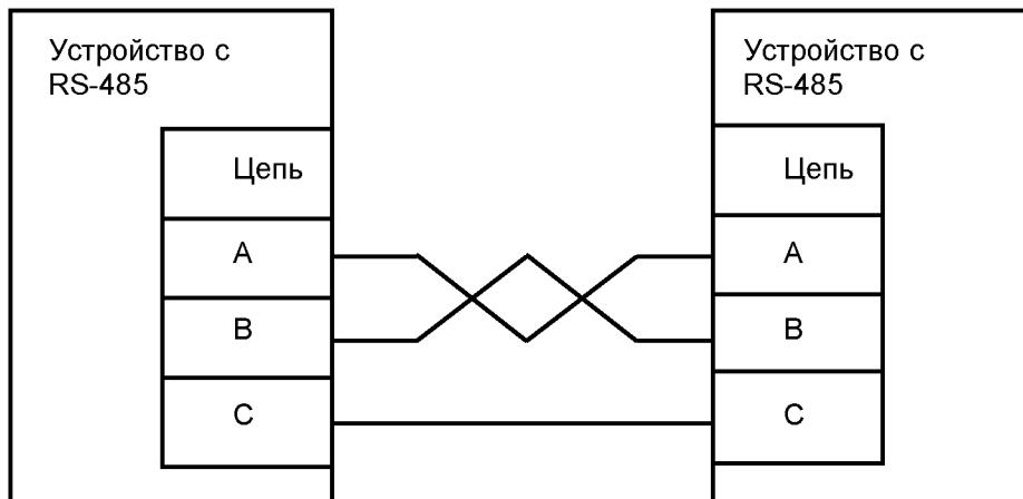
При самостоятельном изготовлении кабеля интерфейса RS-485 последовательно соедините попарно цепи А и цепи В разъёмов RS-485 всех объединяемых устройств кабелем типа «витая пара»; последовательно соедините линии С (общий провод интерфейса RS-485) всех объединяемых устройств.
