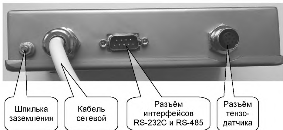
Рис. 4.2. Вид Преобразователя со стороны панели разъёмов для подключения.
