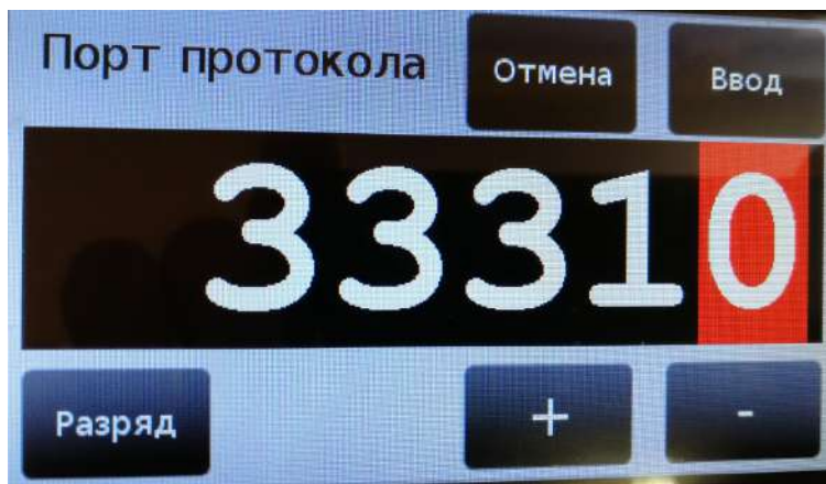
Рис. 8.7.7. Сетевые параметры: изменение номера порта для связи по протоколу «Тензо-М».
