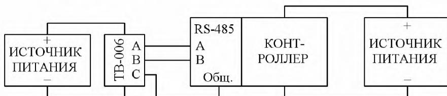
Функцию общего провода RS-485 может выполнять общий провод источника питания, к которому подключены эти устройства:
