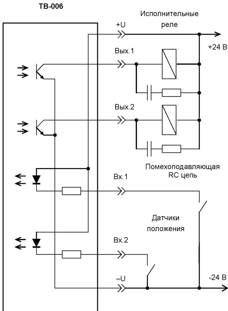
**Включенному** состоянию сигнала соответствует протекание тока по входной или выходной цепи.
