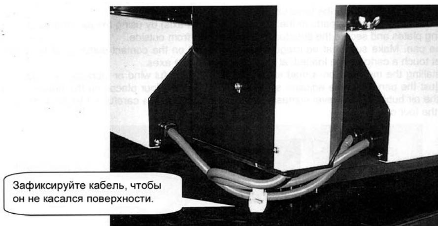
Если кабель будет касаться поверхности, как показано на рисунке ниже, то это может повлиять на точность измерений.
