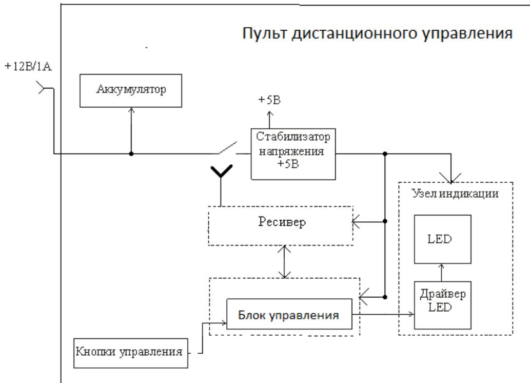
Рис. 3.2 Структурная схема ПДУ
